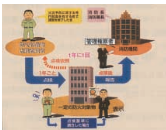
定期点検報告と点検済表示
